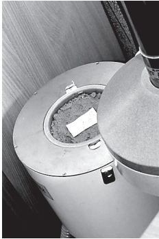
放射線衛生センターで使われているヨウ化ナトリウム検出器(上) 赤十字・モギリヨフ支部の検診車両。州内各地で甲状腺、乳腺の検査が行われる(中) 今回訪問したモギリヨフ州郊外の村は人口約2000人のうち半数が汚染地域からの移住者という話(下)
