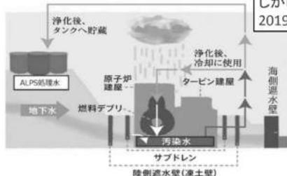
図2. 汚染水発生メカニズムとALPS処理水\*
